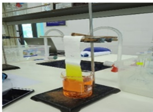
Hình 5. Thiết bị đo độ mao dẫn
